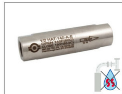
ISC9092 Kit anti-scald per lavaocchi. Previene il surriscaldamento dell'acqua. Una valvola termostatica apre il circuito a 40°C e lo chiude quando l'acqua torna sotto i 35°C. Misura 1/2".
